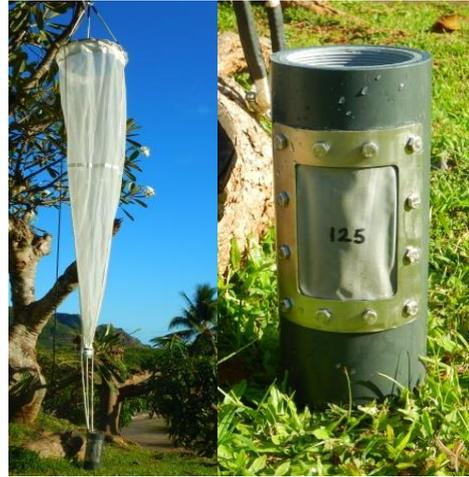
**Figure II.9.** Filet à plancton et collecteur avec grille de maille  $125\text{ }\mu\text{m}$ .
