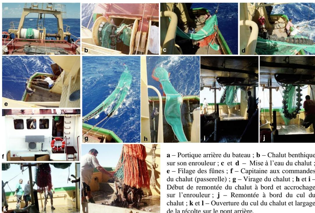
**a** – Portique arrière du bateau ; **b** – Chalut benthique sur son enrouleur ; **c** et **d** – Mise à l'eau du chalut ; **e** – Filage des fûnes ; **f** – Capitaine aux commandes du chalut (passerelle) ; **g** – Virage du chalut ; **h** et **i** – Début de remontée du chalut à bord et accrochage sur l'enrouleur ; **j** – Remontée à bord du cul du chalut ; **k** et **l** – Ouverture du cul du chalut et largage de la récolte sur le pont arrière.
