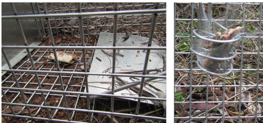
**Figure 4.4.** Dispositif de déclenchement du piège WIRETAINERS® CatTrap (a) et du piège WIRETAINERS® PossumTrap (b)
