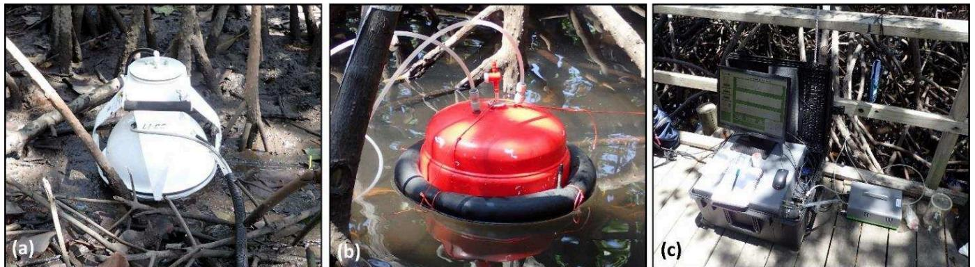
Figure III-1: Photographies (a) d'une chambre d'incubation opaque utilisée à marée basse, (b) d'une chambre d'incubation flottante utilisée à marée haute, et (c) de l'analyseur CRDS utilisé pour mesurer les émissions.
